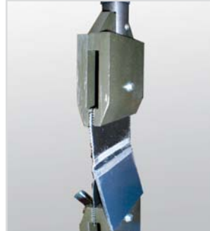
Materialbelastungstest - Zugversuch von Textilien und Bändern
