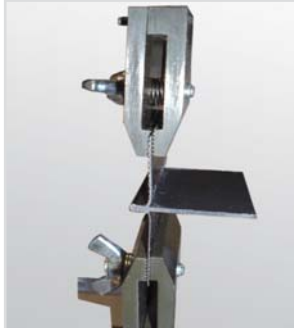
Materialbelastungstest - Zugversuch von Textilien und Bändern
