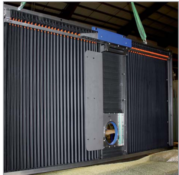
Rückansicht einer Komplettlösung, ELASTIC Faltenbälge in der X-Achse
