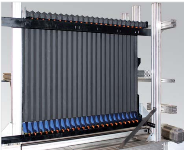
Verfahrttest Faltenbalg, Verschleisstest mit bis zu drei Millionen Zyklen
