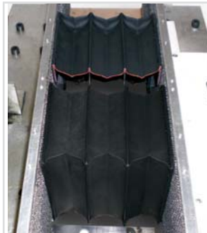
Materialbelastungstest - Knickbruchbeständigkeit in Faltenecken
