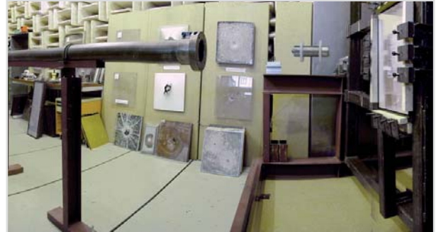
Aufprallprüfung Sicherheitscheiben gemäß DIN EN 12415
