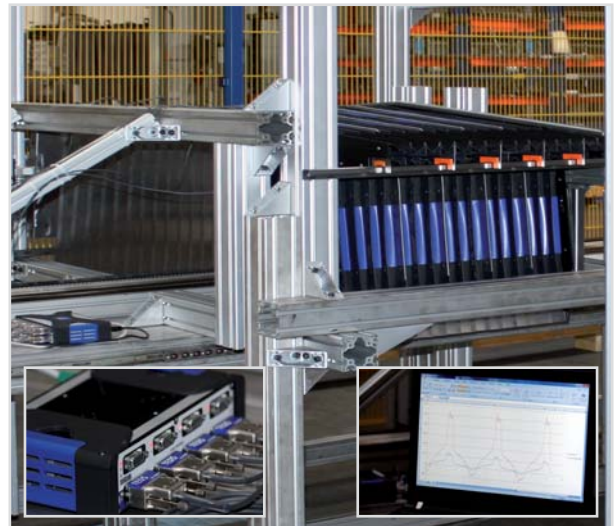
Prüfung statischer und dynamischer Rückstellkräfte
