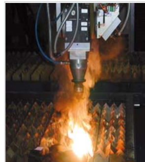
Materialbelastungstest - Laserstrahlgang und Brennverhalten
