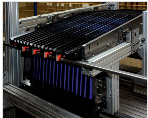
Verfahrttest Vector Faltenbalg mit Beschleunigung bis zu 2 g
