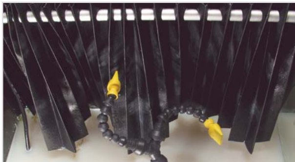
Materialbelastungstest - Kühlmittelsprühversuch, rotierende Düsen
